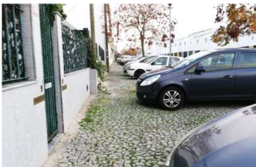
Figura 24: Carros estacionados em espinha diminuem, ou eliminam, a largura útil do passeio.
