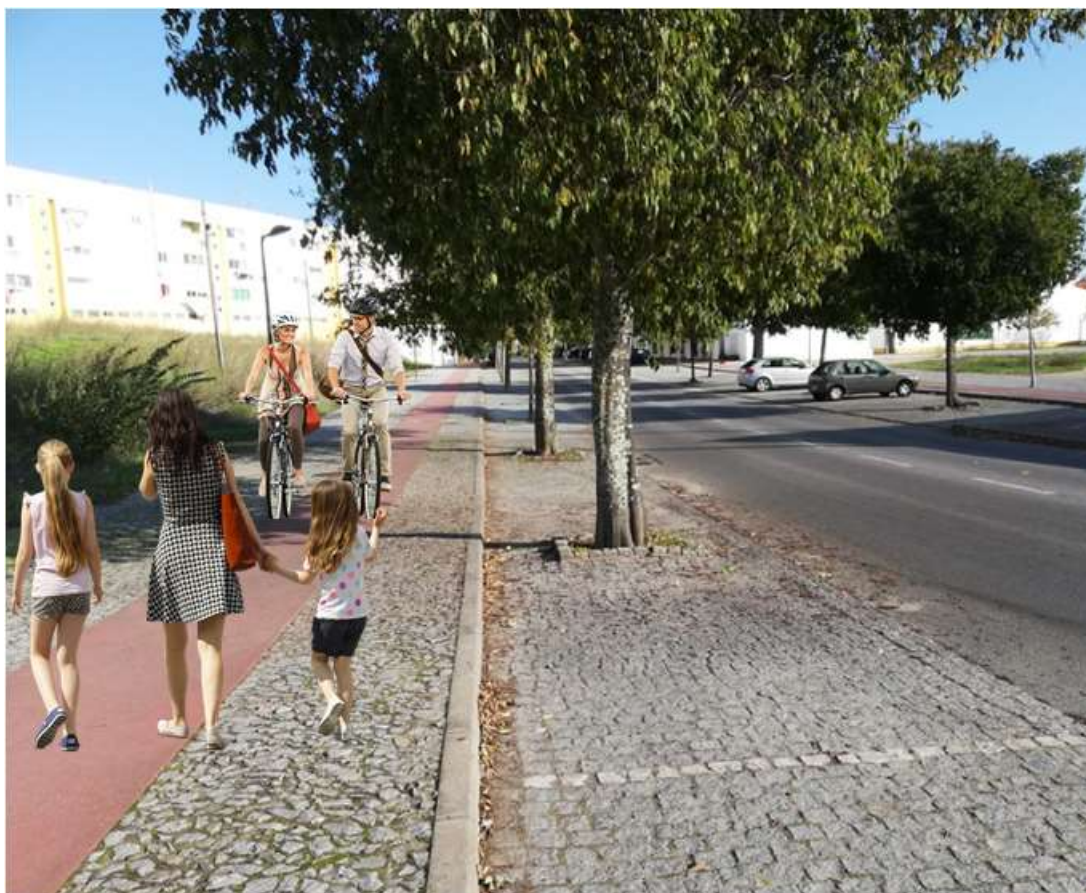
Figura 72: O desenho da ciclovía e do passeio provoca situações potenciais de conflito entre ciclistas e peões.
